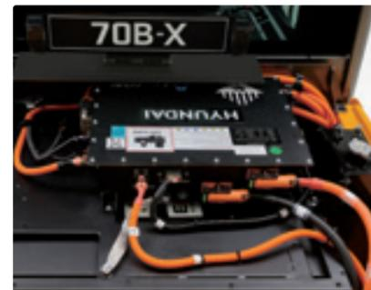
배터리 상태를 실시간으로 모니터링하며, 이상 신호 감지 시 충·방전을 제어하고 필요에 따라 자동 소화 장치를 작동시켜 안전을 확보합니다.
